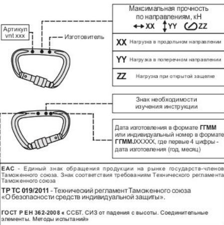
Рис. 3. Приложение нагрузки к карабину
