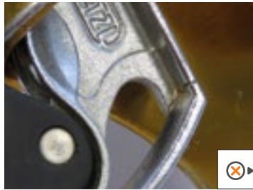
• Трещины на кулачке
