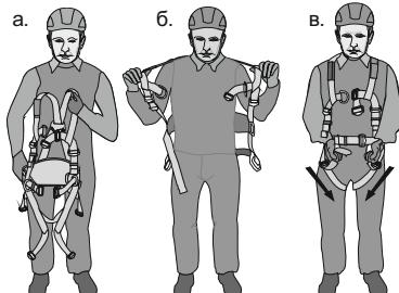
**Рис. 6 Типы используемых пряжек, способы заправки**
