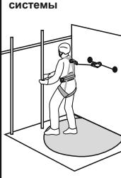
**Рис. 13. Позиционирование в рабочем положении**
