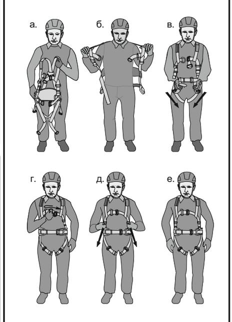
Рис. 6. Типы используемых пряжек, способы заправки
