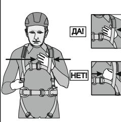
**Рис. 10. Соединительно-амортизирующая подсистема**
