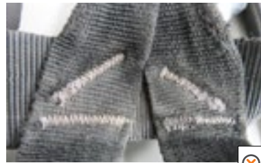
• Поврежденный силовой шов
