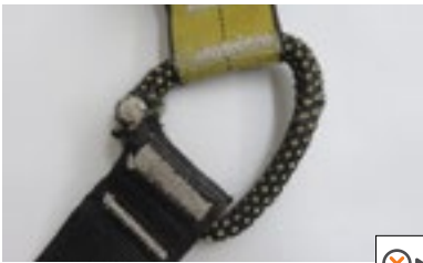
• Поврежденная присоединительная точка
