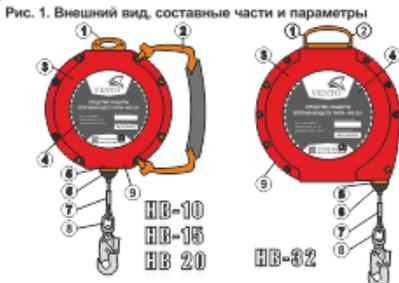
1. Силовой элемент для крепления к анкерному устройству
