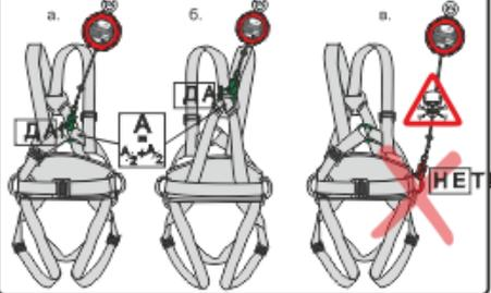
Рис. 6. Ограничения по способу приложения нагрузки относятся ко всем типам карabinов
