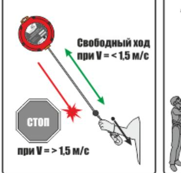
Рис. 4. Соединение НВ с привязью
