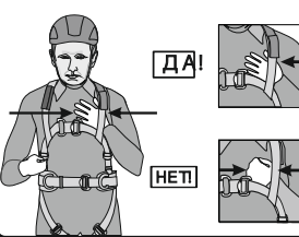
Рис. 11. Способ организации удерживающей системы
